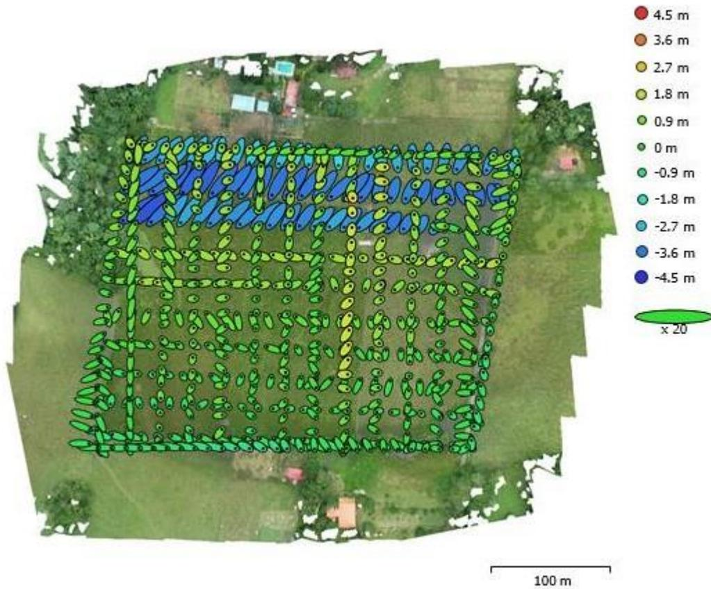
Ilustración 69 Posiciones de cámaras y estimadores de error.
