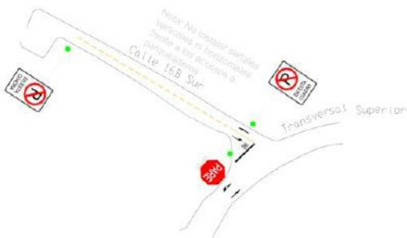
*Figura 6. Señalización propuesta calle 16B Sur con Transversal Superior*
