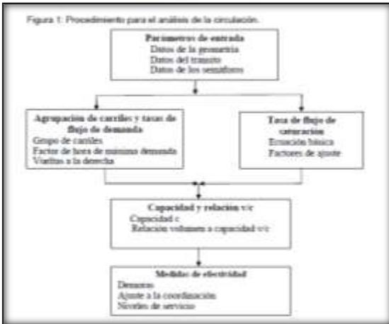
Imagen 3. Procedimiento para determinar el análisis de la circulación. Manual de capacidad de carreteras, (HCM) 1985.
