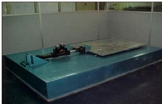
Figura 11: simulador sísmico univalle. Fuente, diseño y construcción del simulador sísmico uniaxial de la universidad del valle.
