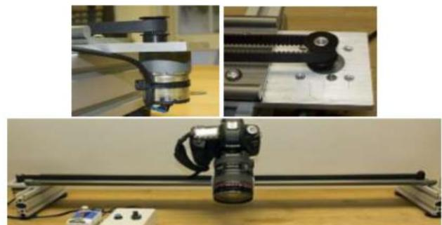
Fig. 4: slider o carril motorizado. Fuente: diseño, prototipaje y caracterización de mesas vibratorias.
