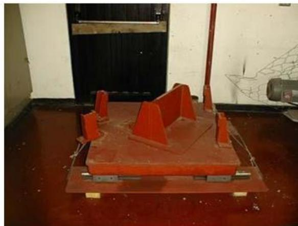
Figura 12: simulador sísmico universidad de los andes. Fuente: diseño y construcción de la cimentación para la mesa vibratoria de la universidad de los andes.
