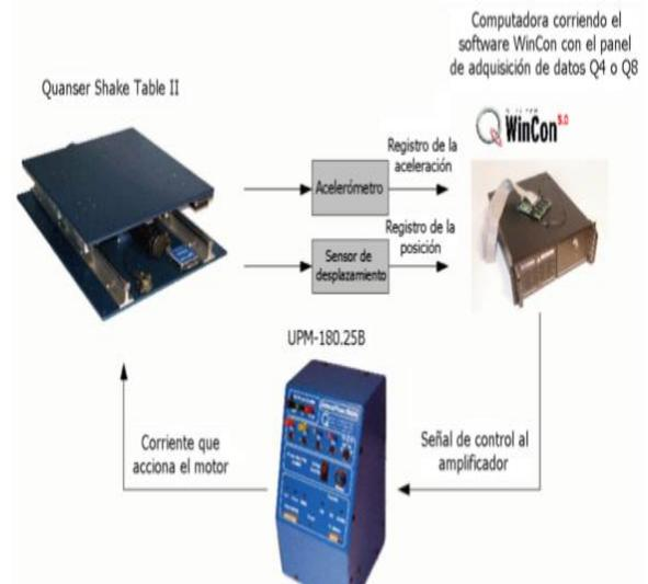
Fig. 9: Componentes del sistema. Fuente: Quancer Consulting inc.
