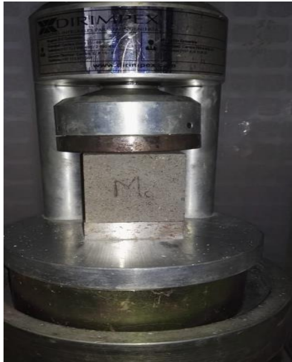
Fotografía 5. Determinación de resistencia a la compresión de morteros.
