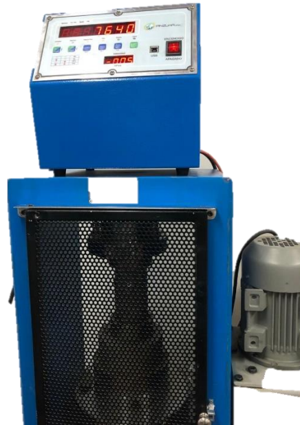
Fotografía 6. Determinación de resistencia a la compresión en los cilindros.
