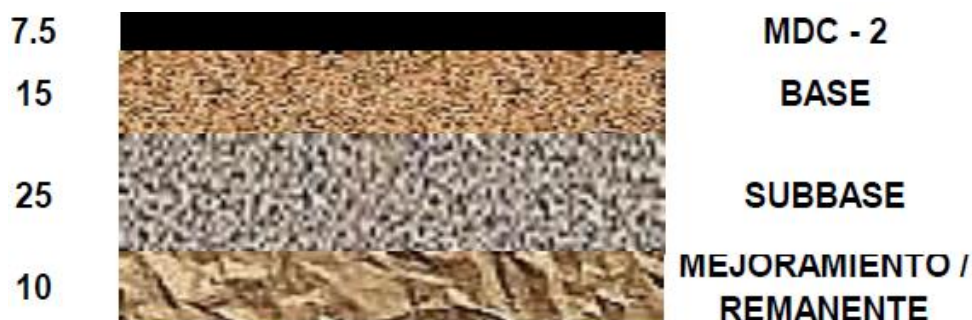
Figura 6 Resultado estructura de pavimento
