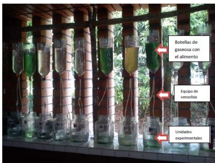
Figura 1. Sistema de alimentación por goteo implementado para el desarrollo del experimento
