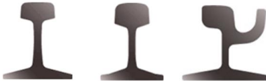
Figura 1 . Perfil tipo de riel: izquierda perfil AREMA, centro perfil UIC; derecha perfil de viga.
